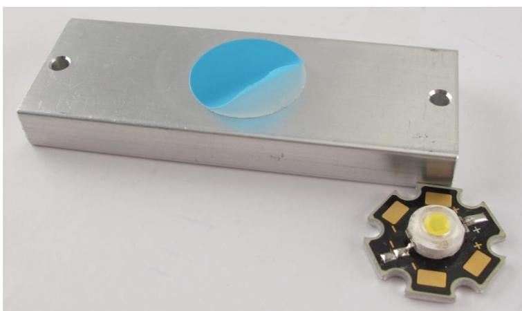
4. Posizionare il led di potenza ed applicare una leggera pressione in modo che il collante a base acrilica aderisca.
