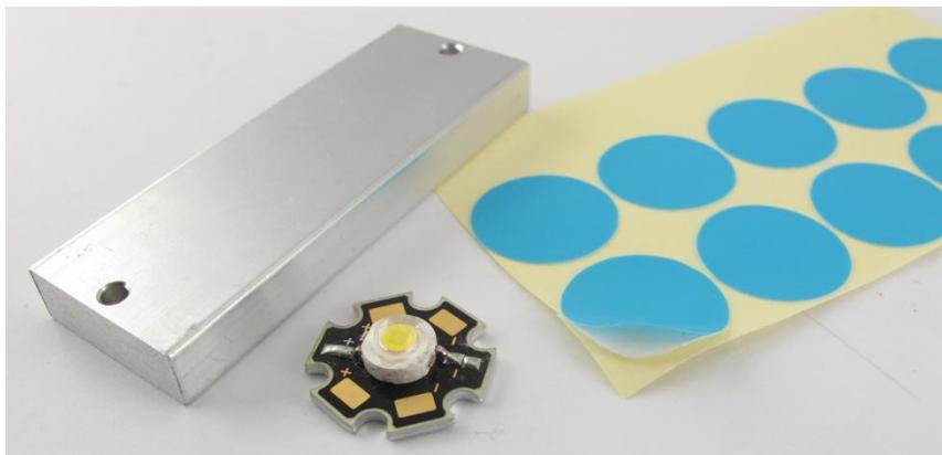
1. Utilizzando alcool isopropilico pulire le superfici di incollaggio.
