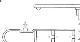
Schroef het batterijdeksel los en plaats 2 x AAA-batterijen. Let op de polariteit, de + pool wijst naar het batterijdeksel.
