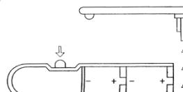
Schrauben Sie den Batteriedeckel ab und legen Sie 2 AAA-Batterien ein. Beachten Sie die Polarität. Der + Pol weist zum Batteriedeckel.
