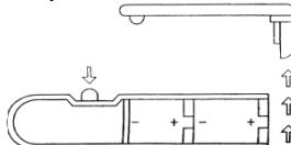
Dévisser le bouchon du compartiment et insérer 2 piles type R03. Respecter la polarité.
