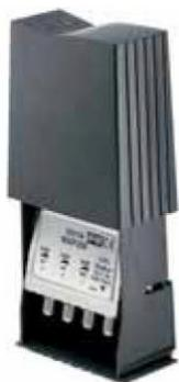
Miscelatori con 2 o 3 ingressi e connettori F, possono essere usati come demiscelatori entrando dal connettore di uscita (Mix). Impedenza 75 Ohm. Fascetta di fissaggio adatta per pali fino a Ø 60mm. Compatibili con i segnali DDT in modulazione COFDM. Temperatura di lavoro da -10 a 55°C. Contenitore in metallo completamente schermato.
