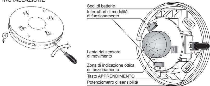
Il sensore può essere montato in qualsiasi luogo usando il nastro biadesivo o mediante due tasselli 5x(3x30) mm.
