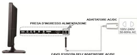
**NOTA:** assicurarsi che l'energia fornita dalla rete elettrica, nel luogo in cui si vuole utilizzare il K-M128D, sia compatibile con le caratteristiche d'ingresso dell'adattatore da rete AC/DC in dotazione.
