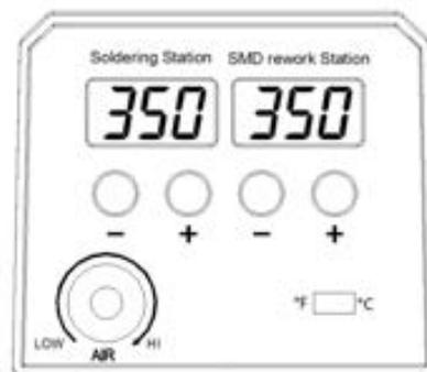
1. Premere il pulsante "+" o "-" per regolare la temperatura. In breve, il settaggio cambia  $\pm 1^{\circ}\text{C}$ . Con una pressione prolungata, il settaggio cambierà rapidamente e raggiungerà la temperatura impostata.
