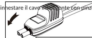
3) Collegare le pinze alla batteria del veicolo, facendo attenzione a collegare la pinza rossa al polo positivo (+) della batteria e la pinza nera al polo negativo (-) della batteria. Il display del cavo intelligente mostra la tensione della batteria se quest'ultima è compresa tra 11V e 14.7V DC. In caso contrario il cavo intelligente si porta in modalità avviamento connettendo l'uscita dell'avviatore alle pinze. In questo caso il display mostra la tensione d'uscita dell'avviatore.
