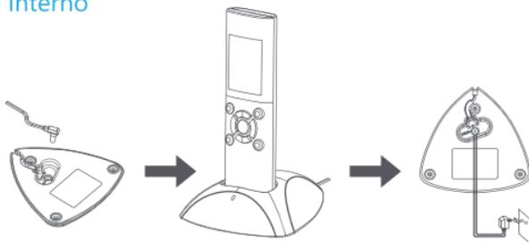
Connettere l'estremità modulare dell'adattatore AC allo spinotto di alimentazione del caricatore, poi collegare l'adattatore AC ad una presa standard a muro.
