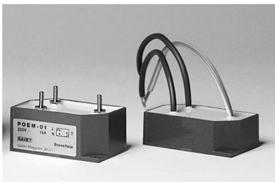
Per applicazioni industriali i modelli POEM-01 (con terminazioni a vite) e POEM-02 (con terminazioni a cavetto), sono protezioni di rete per alimentazione a 230 V~. Esse offrono una protezione veloce contro le sovratensioni trasversali e longitudinali garantendo un livello di protezione massima di 8kA riferito all'impulso normalizzato 8/20 $\mu$ s. Sono realizzate in contenitore plastico resinato, per il montaggio su a pannello con viti.
