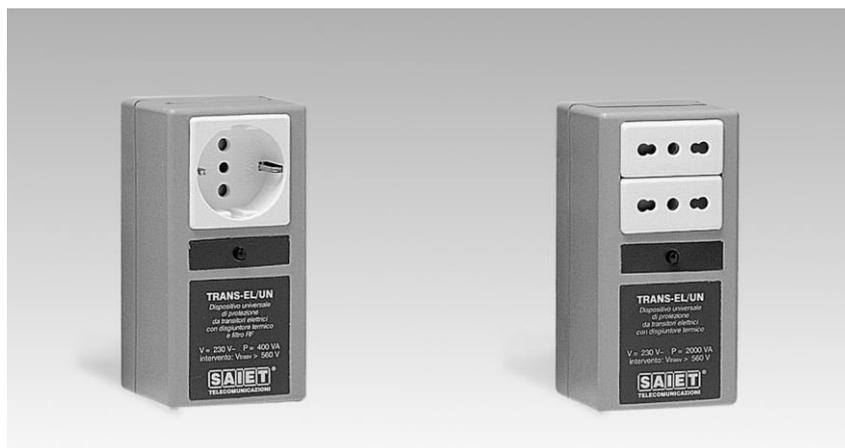
Per applicazioni SOHO autoinstallanti i modelli UN-01, UN-02 sono protezioni di rete per alimentazione a 230 V~. Esse offrono una protezione veloce contro le sovratensioni trasversali e longitudinali garantendo un livello di protezione massima di 8kA riferito all'impulso normalizzato 8/20µs. Sono realizzate in contenitore plastico e offrono una presa shuco o due italiane.
