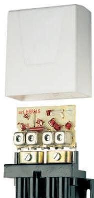
Miscelatori con 2 o 3 ingressi, possono essere impiegati come demiscelatori entrando dal morsetto miscelato (Mix). Impedenza 75 Ohm. Fascetta di fissaggio adatta per pali fino a Ø 60mm. Compatibili con i segnali DDT in modulazione COFDM. Temperatura di lavoro da -10 a 55°C.
