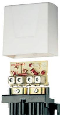
Amplificano il segnale proveniente da una o due antenne e sono dotati di una uscita amplificata. Contenitore di plastica a prova di pioggia. Telealimentabili via cavo, 12VDC. Fascetta di fissaggio adatta per pali fino a Ø 60mm. Compatibile con i segnali DTT in modulazione COFDM. Temperatura di lavoro: -10 a 55°C.
