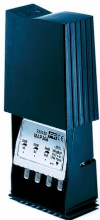
Amplificatore da palo a singolo ingresso ad amplificazione unica. Compatibile con i segnali DTT in modulazione COFDM. Completo di fascetta di fissaggio a palo adatta a pali fino a Ø 60mm. Telaio completamente schermato con connettori di tipo F femmina per una semplice connessione dell'apparato. L'innovativo sistema di bloccaggio del contenitore plastico e la rotazione del telaio metallico garantiscono massima sicurezza e velocità nell'installazione
